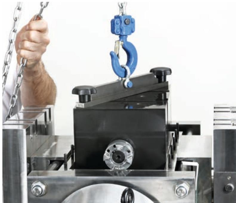
Bild 2: In maximal 180 Minuten ist der Prüfstand umgerüstet und mit neuen Wälzlagern bestückt.
